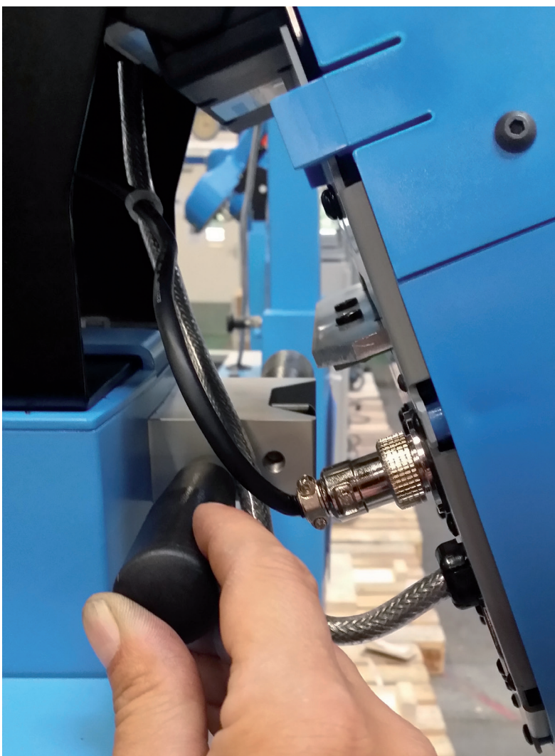
Het ontgrendelen van de kop met een drukknop om hem te kunnen verstellen.
