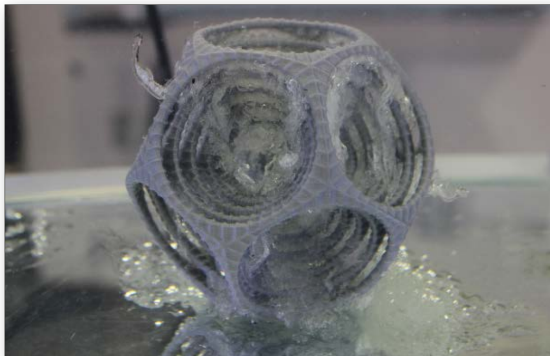
Met het dubbelextrusiesysteem in de Ultimaker 3 kan bijvoorbeeld in wateroplosbaar PVA als steunmateriaal worden meegeprint.
