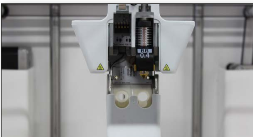
De eenvoudig verwisselbare ‘print cores’ in de printkop van de Ultimaker 3 zijn geoptimaliseerd voor Ultimaker's eigen printmaterialen om een herhaalbare output van hoge kwaliteit te kunnen waarborgen.
