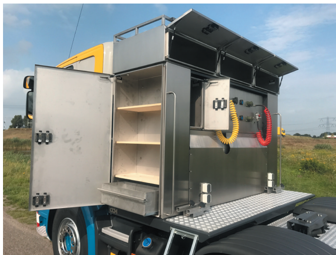
Bansbach easylift gasveren, toegepast in vrachtwagenkisten.
