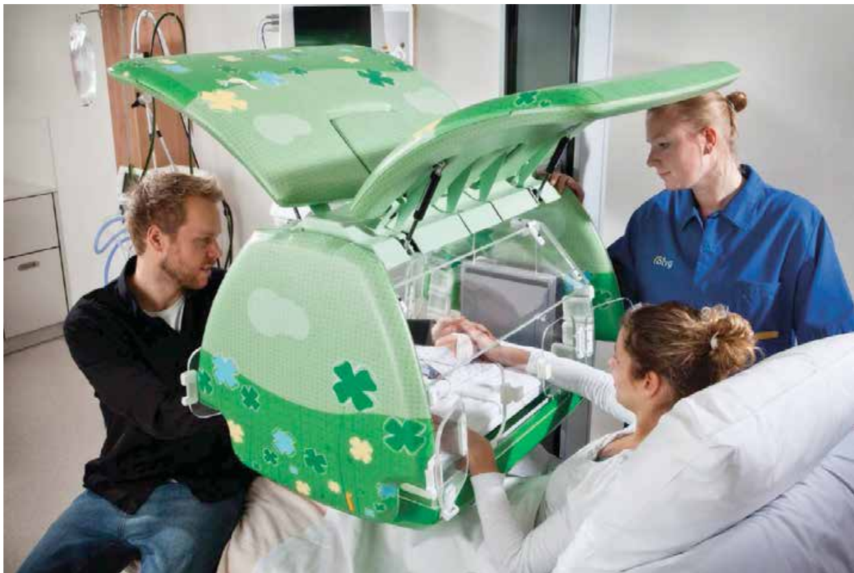
Door het plaatsen van de klimaatapparatuur aan de kopse kant, kan de couveuse boven het bed bij de moeder worden gebracht.
