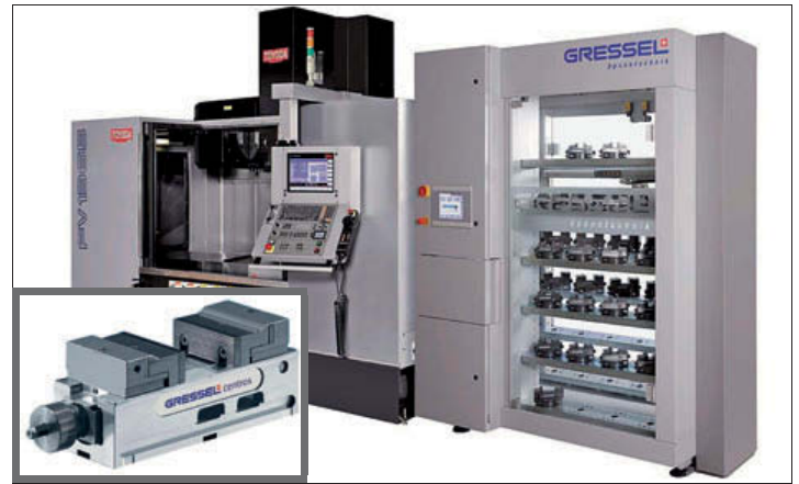
Deze machineklem is zelfcenterend (inzet) en voorzien van een snelopspanstelsel. In combinatie met een nulpuntsysteem en een palletmagazijn (rechts) kan men hiermee een snelle en quasi volautomatische productie tot stand brengen
