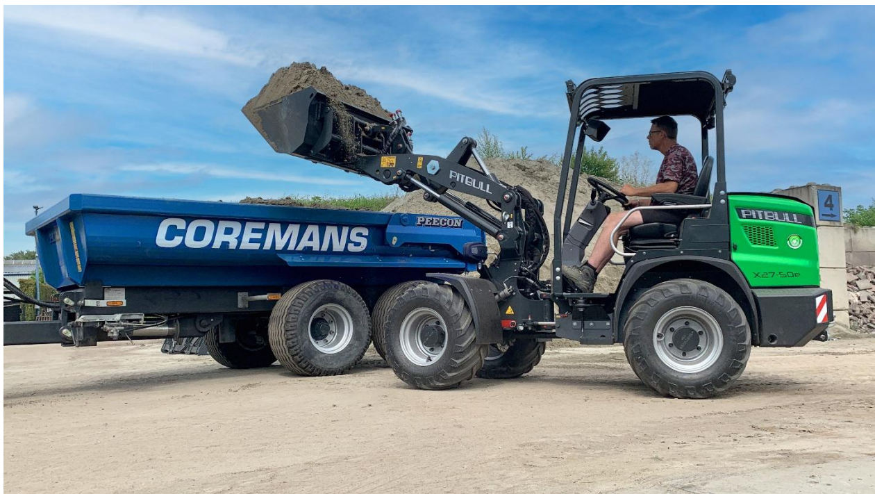
Figuur 2 Elektrisch aangedreven wiellader van Pitbull met heavy-duty joystick-configuratie van elobau.
