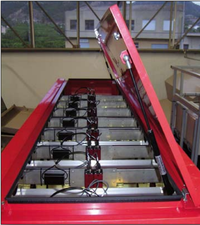
Afbeelding 3. Het visioncompartiment van een Aweta-scaninstallatie. De gasveer trekt de kap bij sluiting in de pakking om het compartiment stofdicht af te sluiten.
