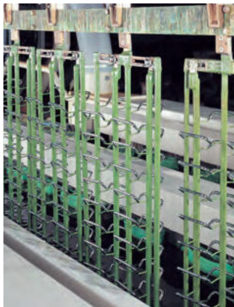
Werkbild: Rohde Rund-Stahlgriffe Typ ST im Galvanoautomat nach dem Vernickeln Picture made by: Rohde Round steel rod handles typ ST after nickel plating in the automatic electroplating plant
